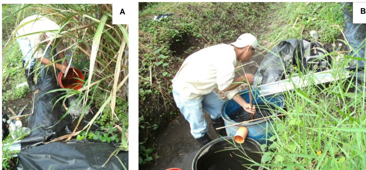
**Figura 19: Toma de muestras. A) Limpieza del canal y B) agitación del material colectado**
