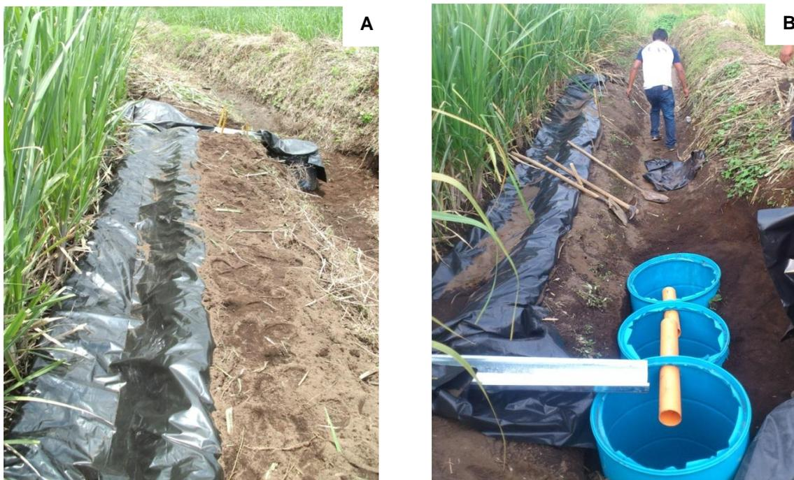
**Figura 17: Sistema colectores de escorrentía y sedimentos. A) Canal de conducción y B) recipientes colectores.**
