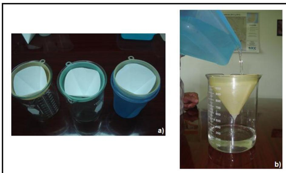
**Figura 40:** a) Papel filtro, embudos y beakers para separar lo sólido y líquido b) filtración del agua que no pudo absorber el poliacrilato de potasio.
