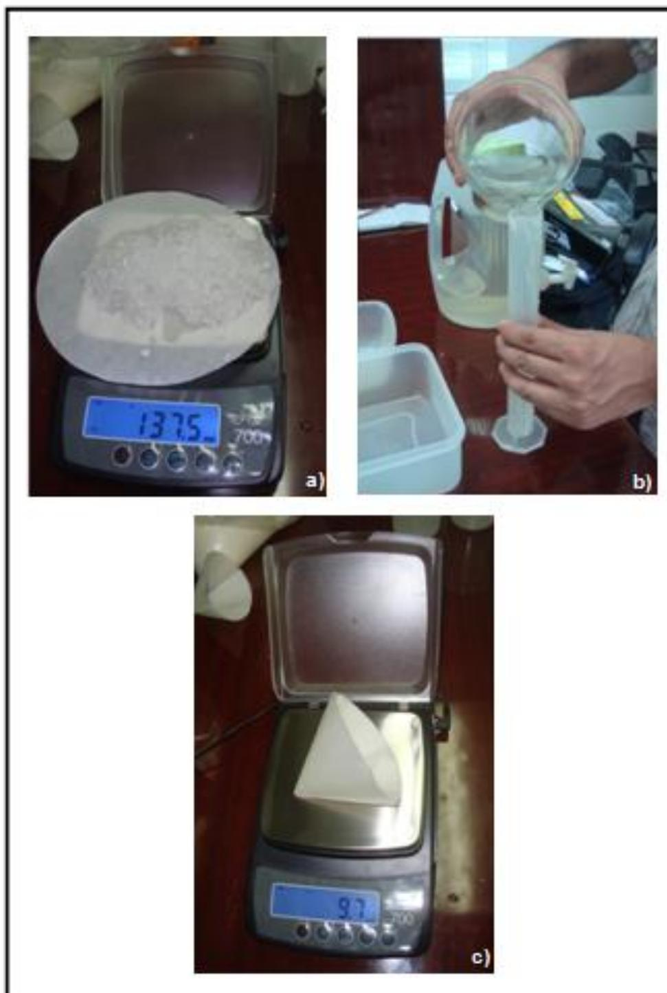
Figura 42: a) Peso del poliacrilato de potasio hidratado b) medición del volumen de agua que no pudo ser absorbido c) peso del papel filtro mojado.
