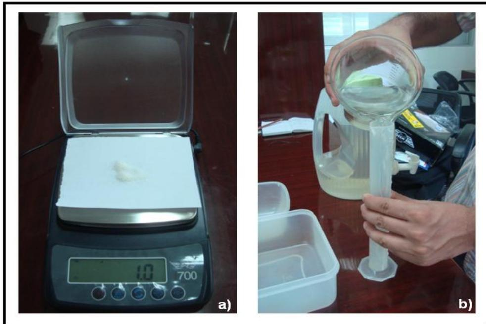
**Figura 38: a) Peso de un gramo de poliacrilato de potasio en la balanza semi-analítica b) Medición de los volúmenes de agua para los tratamientos de 700 ml, 500 ml, 300 ml, 100 ml y 50 ml.**
