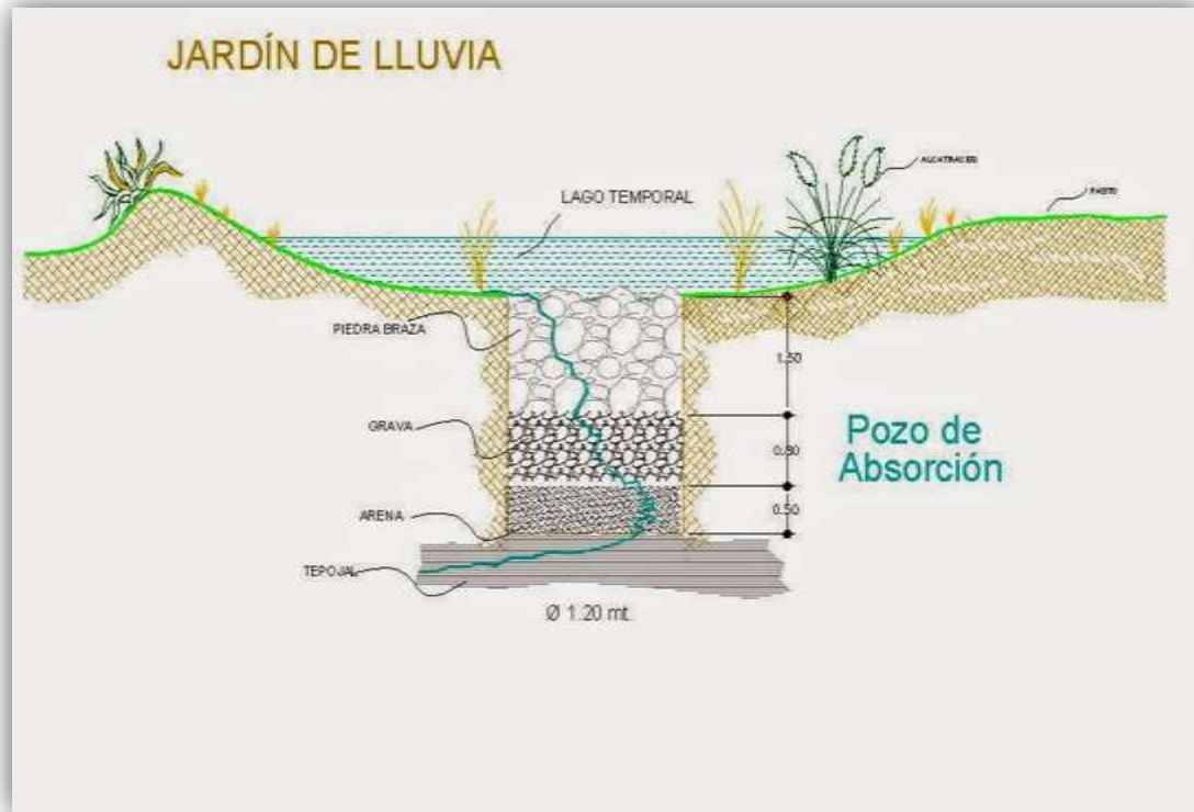
Pozo de infiltración en jardín Fuente: Silva D.
