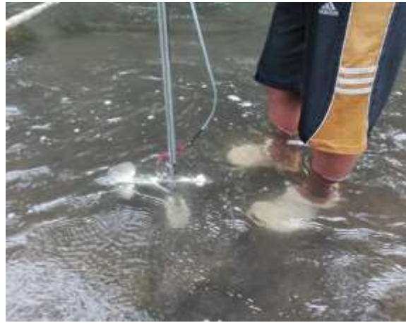
Fotografía 4. Molinete OTT C-31
