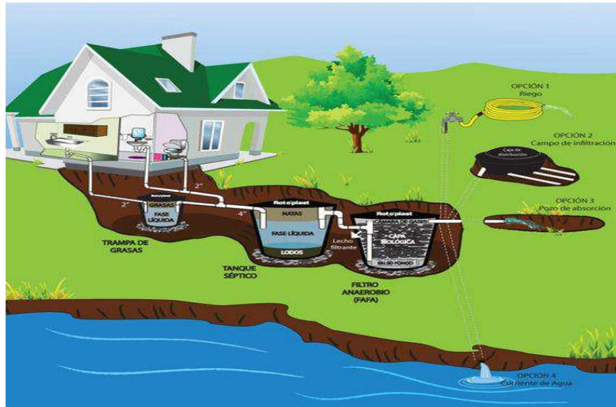
**Figura 7.** Infiltración de agua residual luego de ser tratada en pozos de absorción o en campos de infiltración. Fuente: Rotoplast (s.f.)
