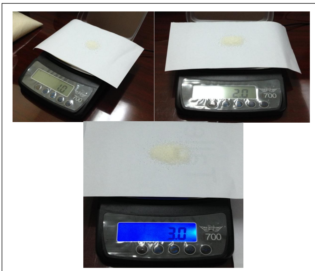
Figura 23. Peso de 1gr, 2gr y 3gr de poliacrilato de potasio a hidratar.
