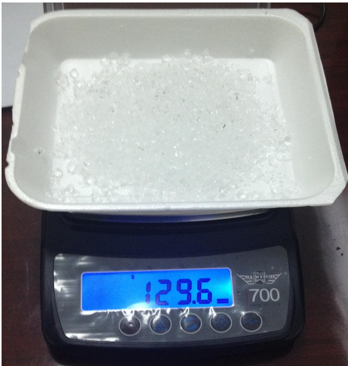
Figura 27. Peso del poliacrilato de potasio luego de haberse hidratado y secado
