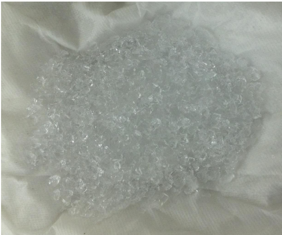
Figura 26. Secado de poliacrilato de potasio hidratado en papel absorbente.
