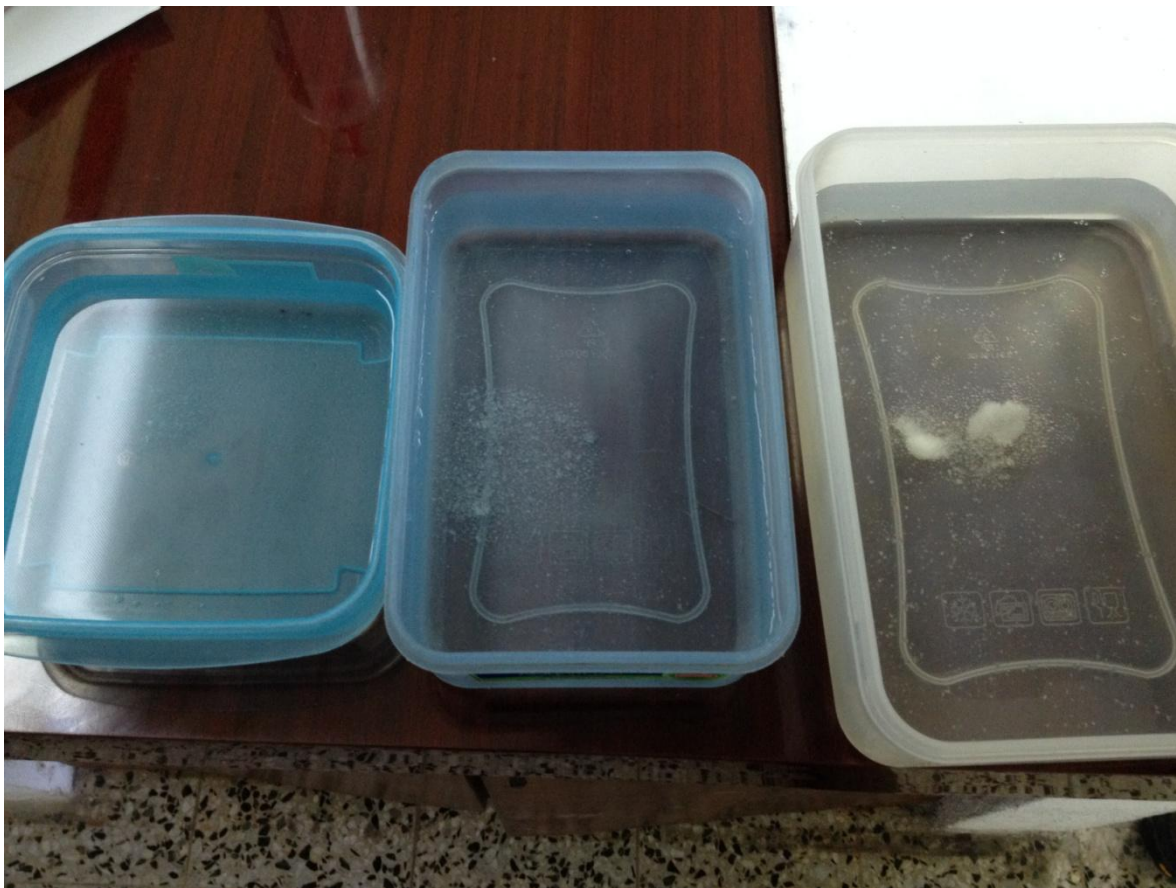
Figura 25. Hidratación del poliacrilato de potasio por una hora
