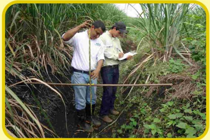
Medición de la erosión en acequias de ladera finca Sujuyes, Santa Lucía Cotzumalguapa Foto por: ICC
