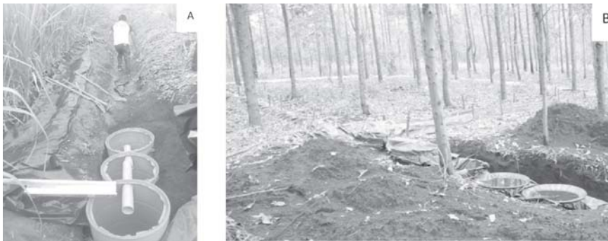
Figura 1: Parcelas de escurrimiento: A) Sistema colector de sedimentos y agua en cultivo de caña de azúcar y B) Sistema colector de sedimentos y agua en plantación forestal (eucalipto).
