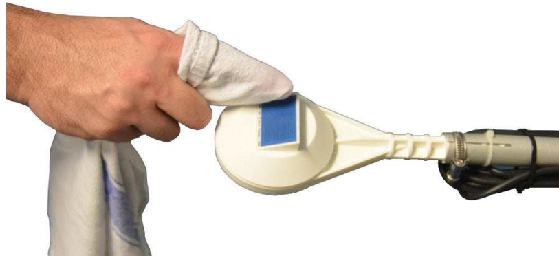
Figura 69. Limpieza del Humectómetro
