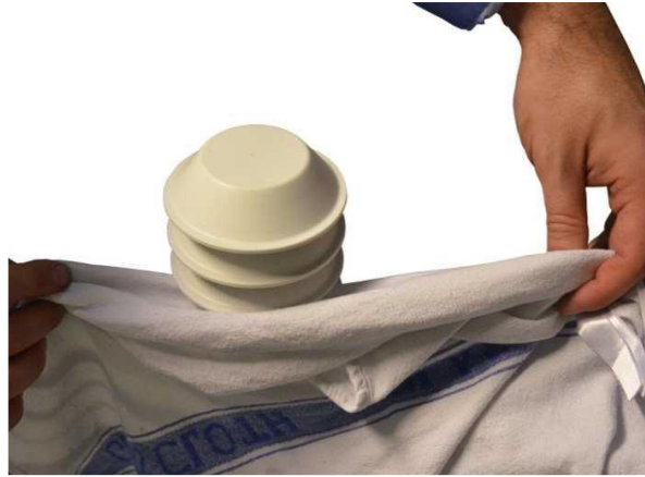
Figura 70. Limpieza del escudo protector
