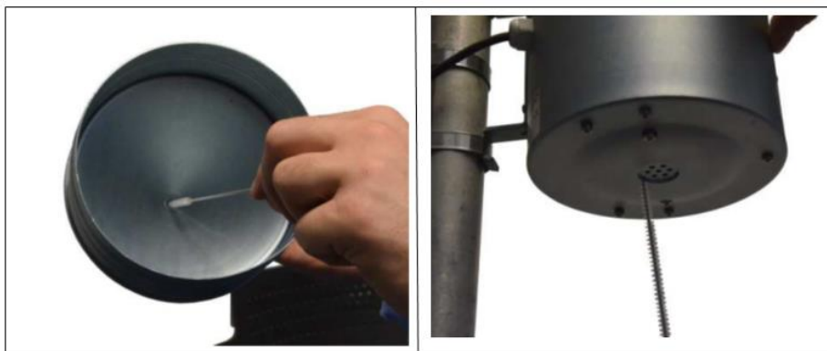
Figura 67. Procedimiento de limpieza del embudo
