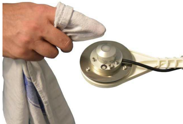
Figura 72. Procedimiento para limpiar el cristal del piranómetro
