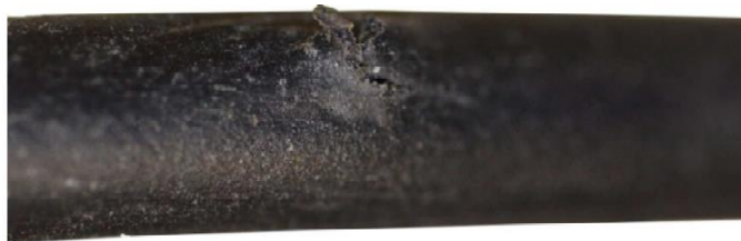
Figura 65. Cable cortado por animal
