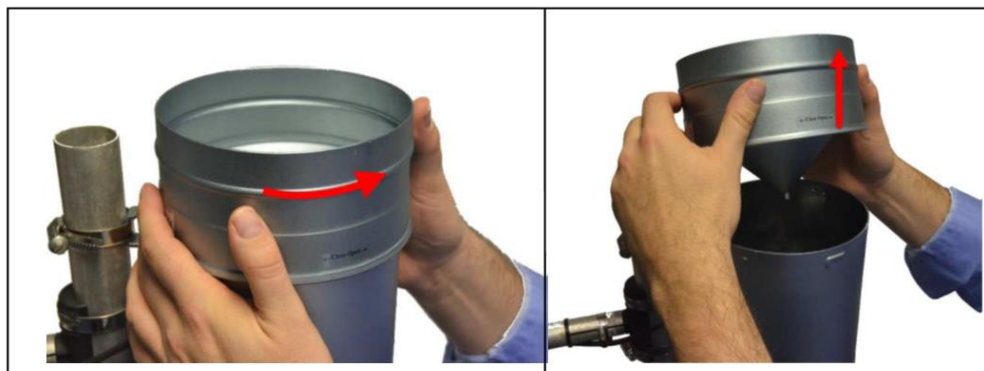
Figura 66. Procedimiento para retirar el embudo
