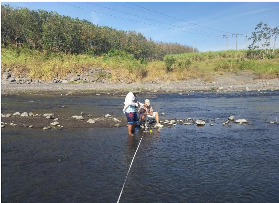
Figura 13. Aforo por el método de sección- velocidad.
