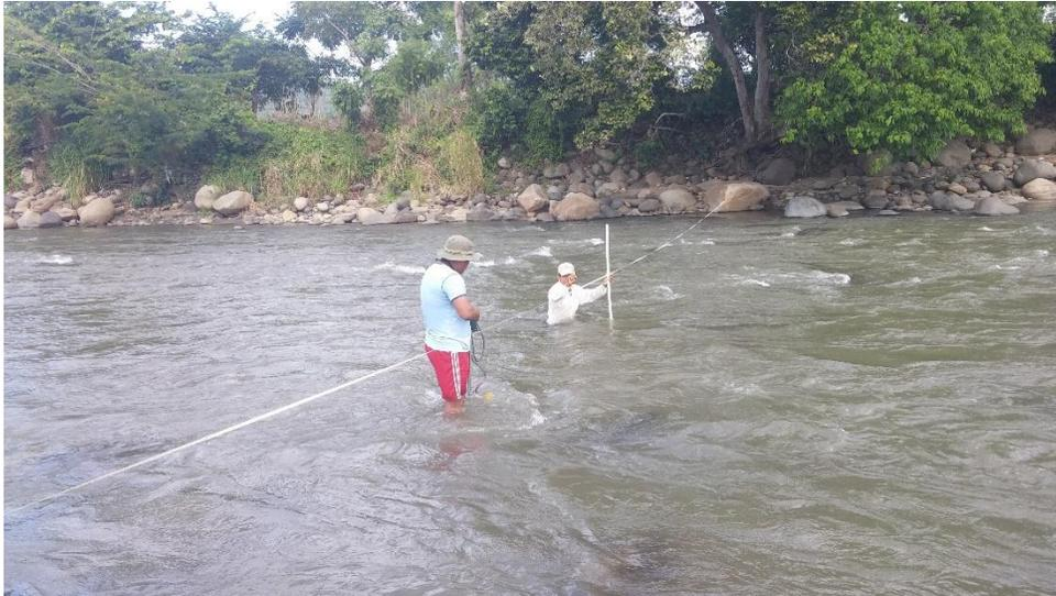
Figura 8. Mediciones de profundidad para cada sección del cauce.
