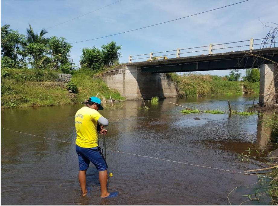
Figura 14. Medición de la velocidad utilizando el molinete
