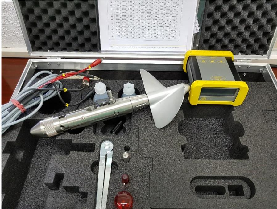
Figura 12. Componentes del molinete OTT C31.
