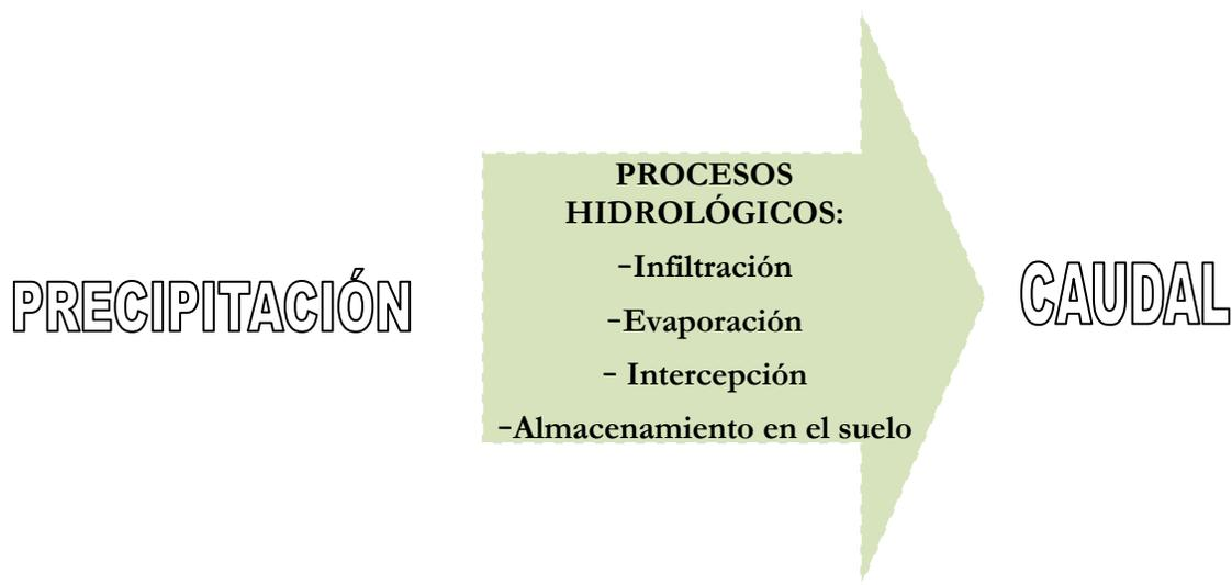
Figura 7. Esquema de funcionamiento de los modelos precipitación-escorrentía.
