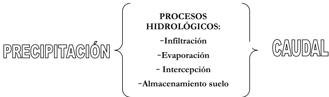
Figura 8. Esquema de funcionamiento de los modelos precipitación-escorrentía.
