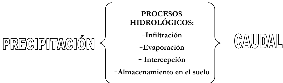
Figura 8. Esquema de funcionamiento de los modelos precipitación-escorrentía.
