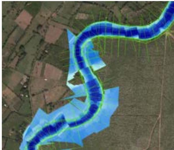
Figura 11. Resultados del modelo basado en las secciones iniciales. Se utilizó para identificar los tramos con mayor susceptibilidad a desborde.
