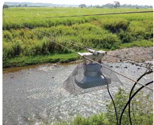
Figura 7. Sensor OTT RLS para la medición del nivel de agua en el río Madre Vieja.
