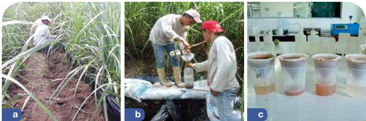
Figura 23. Parcelas de escorrentía. a. Instalación, b. Toma de muestras y c. Análisis de muestras.
