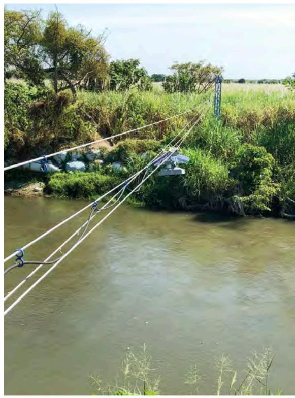
Figura 6. Sensor OTT RLS para la medición del nivel de agua en el río Madre Vieja en su desembocadura.
