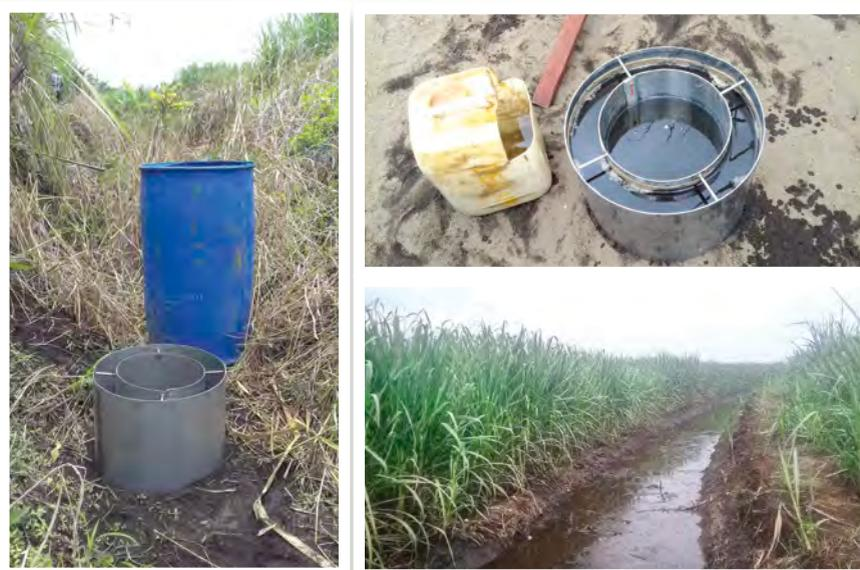
**Figura 30.** Pruebas de infiltración en acequias de ladera y acequia funcionando durante época lluviosa.
