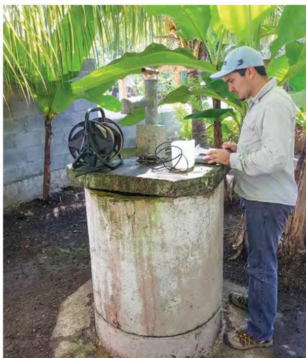
**Figura 11.** Medición del nivel del agua subterránea en pozos artesanales (punto de monitoreo).
