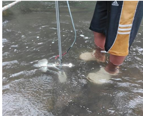
Anexo 4. Molinete OTT C-31 utilizado en campo.
