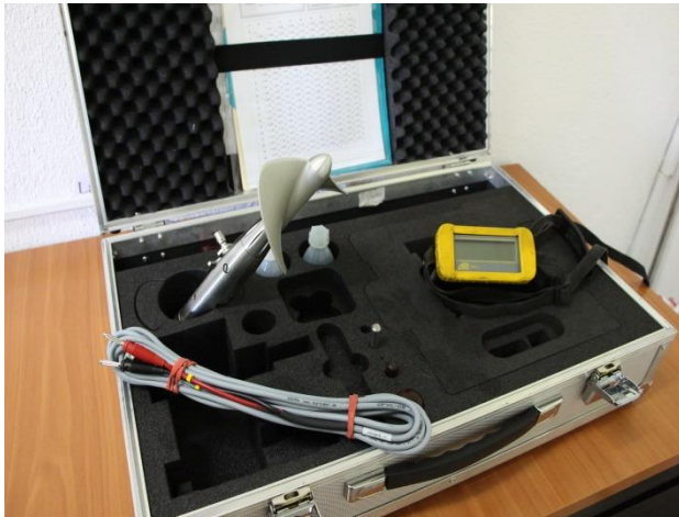
Anexo 4. Molinete OTT C-31 utilizado en campo.
