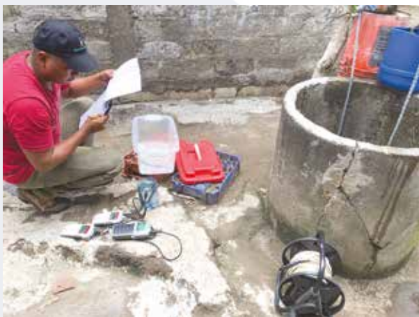
Figura 12. Medición del nivel piezométrico y calidad del agua subterránea en pozos artesanales.
