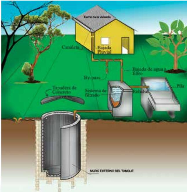
**Figura 77.** Ejemplo ilustrativo de la adecuación de elementos constructivos de una vivienda (techo canal), que aprovecha la alta precipitación pluvial para el posterior almacenamiento del agua de lluvia.
