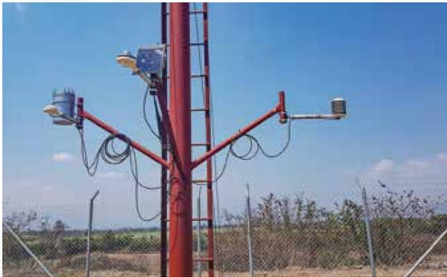
**Figura 9.** Sensores de medición de variables meteorológicas. De izquierda a derecha: termohigrómetro, piranómetro, pluviómetro, humectómetro.
