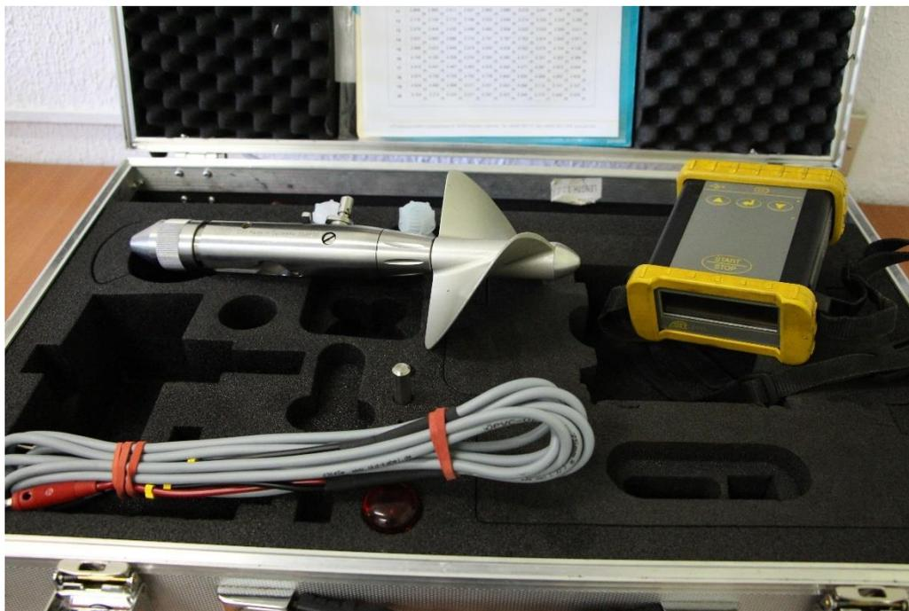
**Figura 70.** Molinete OTT C-31 utilizado para aforar.
