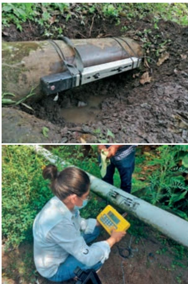
**Figura 13.** Medición de caudales en tuberías, empleando caudalímetros ultrasónicos.
