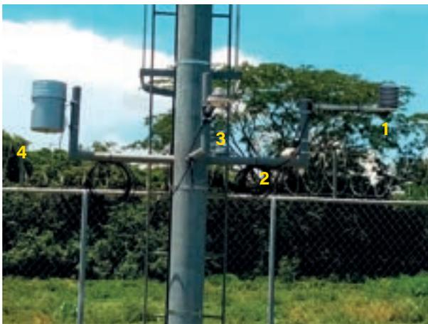
**Figura 6.** Sensores de medición de variables meteorológicas. De derecha a izquierda: termohigrómetro (1), humectómetro (2), piranómetro (3) y pluviómetro (4).
