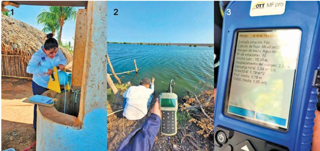
**Figura 97.** Parte del equipo adquirido con fondos de la Fundación Luis von Ahn: 1) Sonda de nivel; 2) Sonda multiparamétrica, y 3) MF pro.
