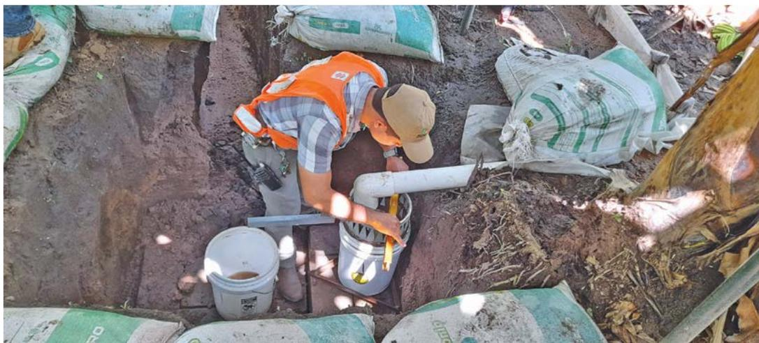
**Figura 59.** Instalación de dispositivos que facilitan la recolección de muestras de sedimentos en campo.
