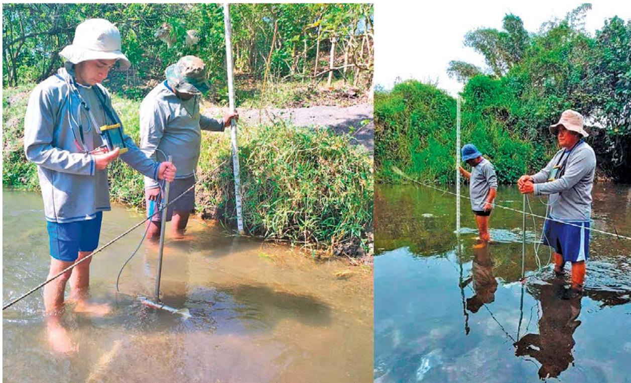
**Figura 1.** Medición del caudal en ríos de la vertiente del Pacífico.
