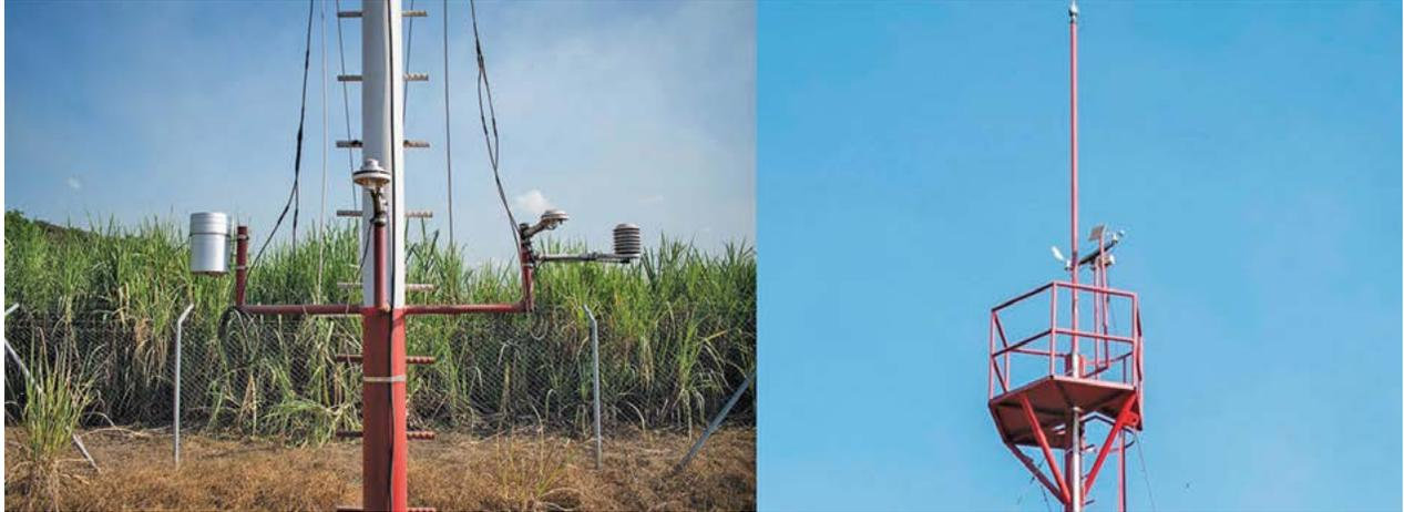
**Figura 6.** Sensores de medición de variables meteorológicas.
