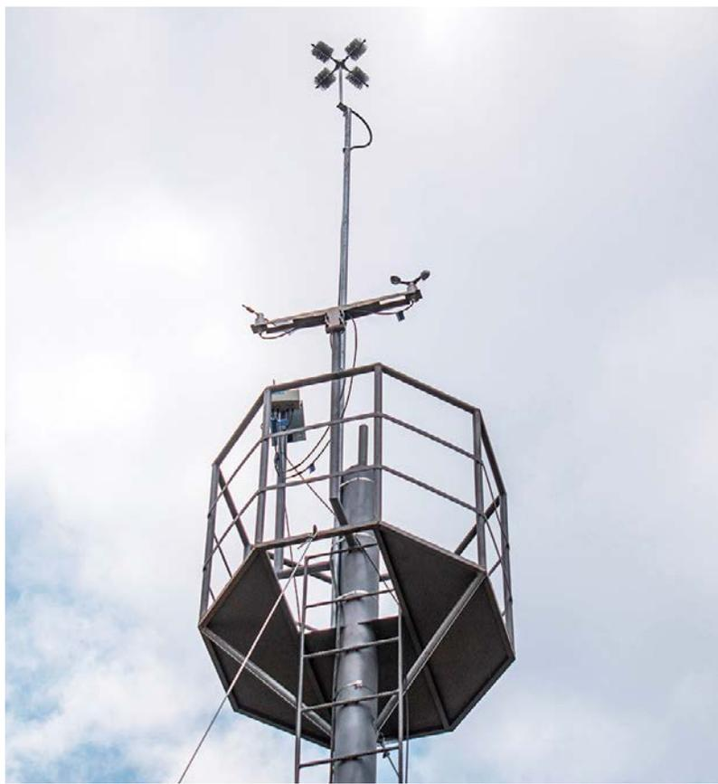
**Figura 8:** Sensores de medición de variables meteorológicas.
