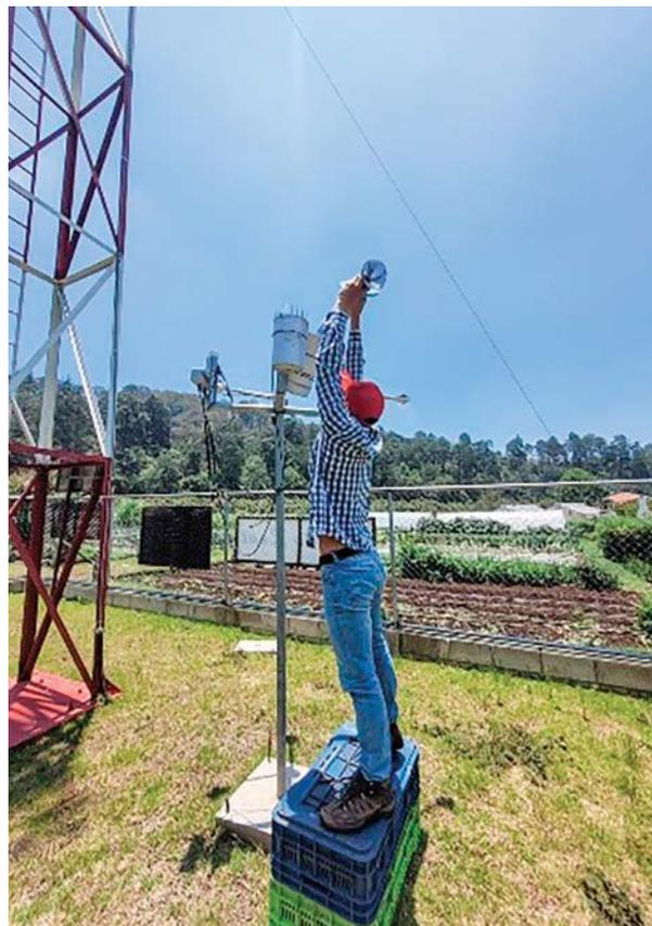
**Figura 11:** Recolecta de muestras de agua de lluvia para análisis de Cl, -,  $\delta^{18}\text{O}$  y  $\delta^2\text{H}$ .
